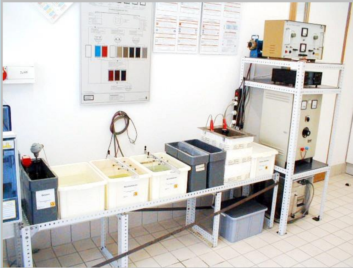
Laboranlage zum Eloxieren
