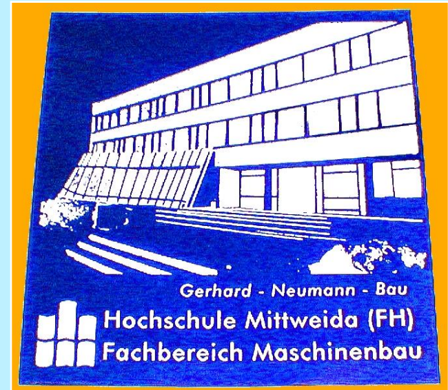
Strukturierte Emaillierung (Weiß-Emaille durch Siebdruck aufgetragen)
