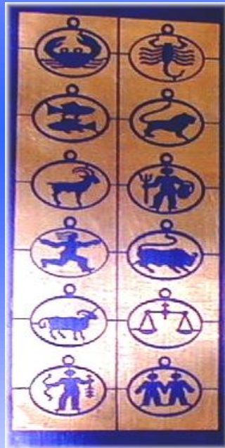
Festresistmaske (belichtet, entwickelt)
