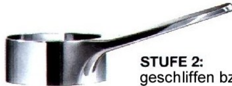
STUFE 1: roher Spritzling aus Zinkdruckguß
