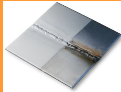
geschweißtes Edelstahlblech, teilw. gebeizt mit ElpoNox
