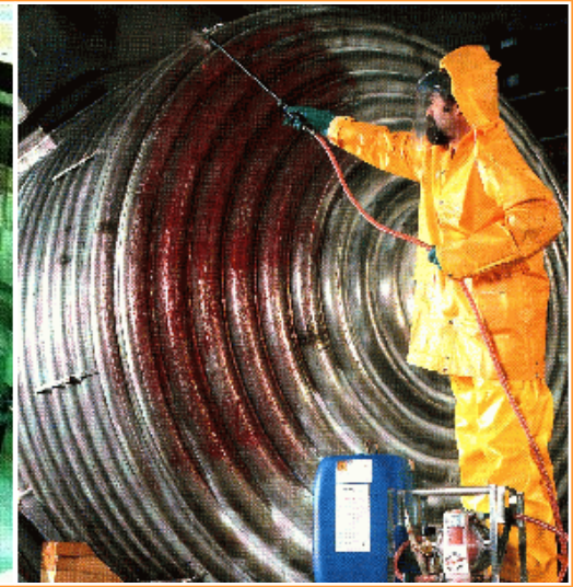
Sprühbeizen mit \text{HF} / \text{HNO}_3
