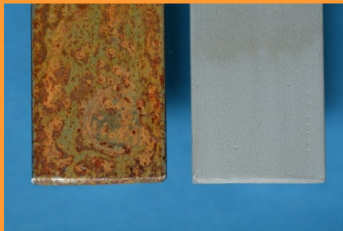
Stahlblech, r. gebeizt mit HCl konz.
