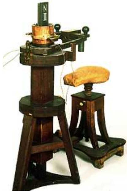
Erster elektromagnetischer Telegraph von 1833
