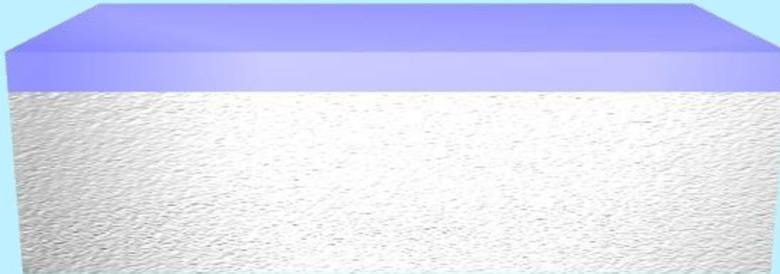
Anodische Oxidation des Aluminiums zur  $\text{Al}_2\text{O}_3$ -Schicht
