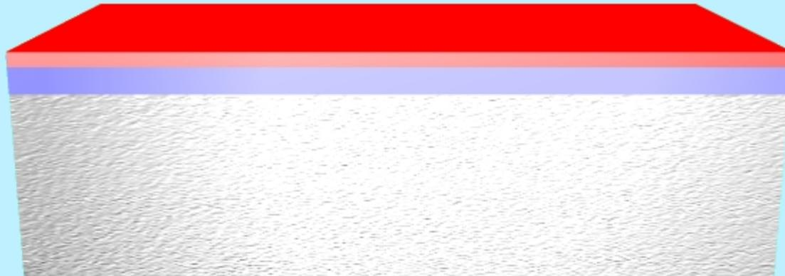
Einlagerung von Farbstoff bzw. Metall in die Poren der Oxidschicht
