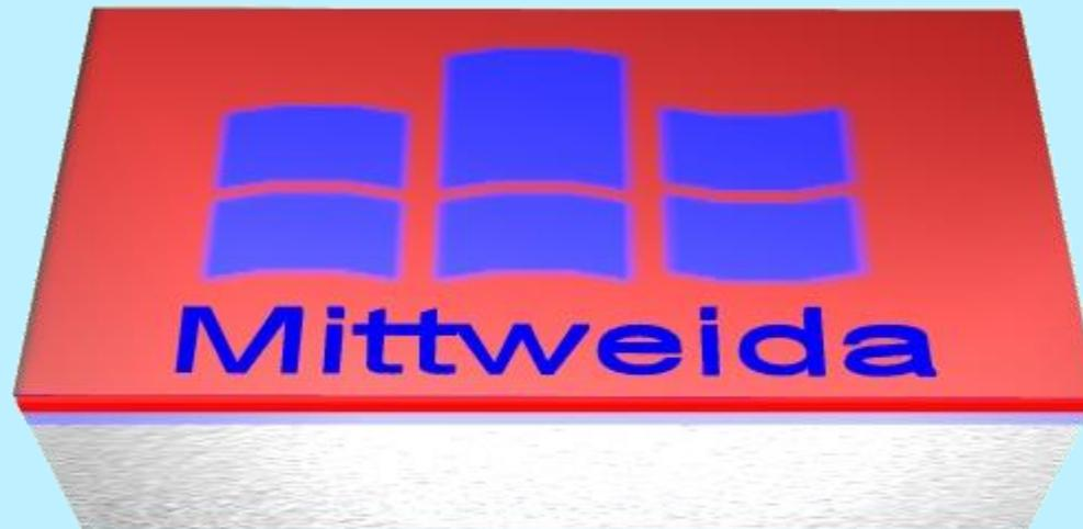
Freigelegte Flächen wurden entfärbt (roter Farbstoff herausgelöst) und anschließend wieder blau eingefärbt
