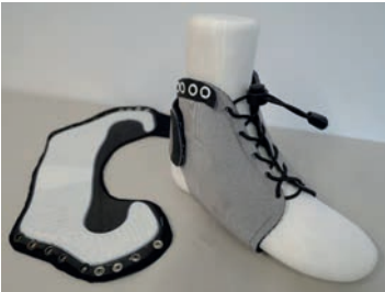
Abb. 2: Knöchelorthese mit integrierten Heizdrähten. Links in flachen gedruckten und rechts in angeformten Zustand
