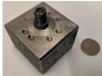
Abb. 1: Kubischer Drucktank, hergestellt im PBF-LB-Verfahren aus amorphem Metall
