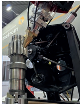
Abb. 1: mittels Laserauftragschweißen wiederhergestellte Verzahnung an einer Welle
