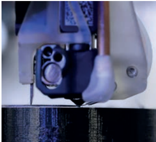
Abb. 1: WEAM-Druckkopf mit Ø 0,2 mm Heizdraht
