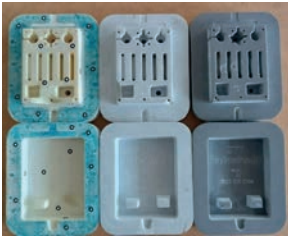
Abb. 1: Spritzgussformen: 100% BASF links, 20% Anycubic mittig, 30% Loctite rechts
