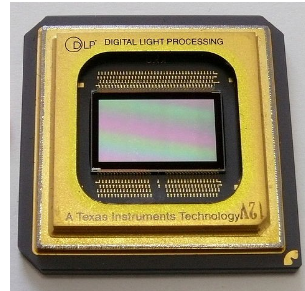
Micro-Spiegelarray wie z.B. in Beamern verbaut
